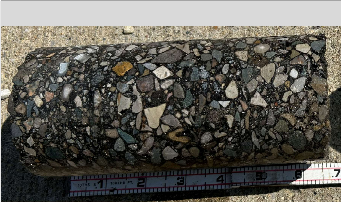
Photo 19: SB-2026-126 (S. Huron Pkwy.): 8.5-inch Asphalt
