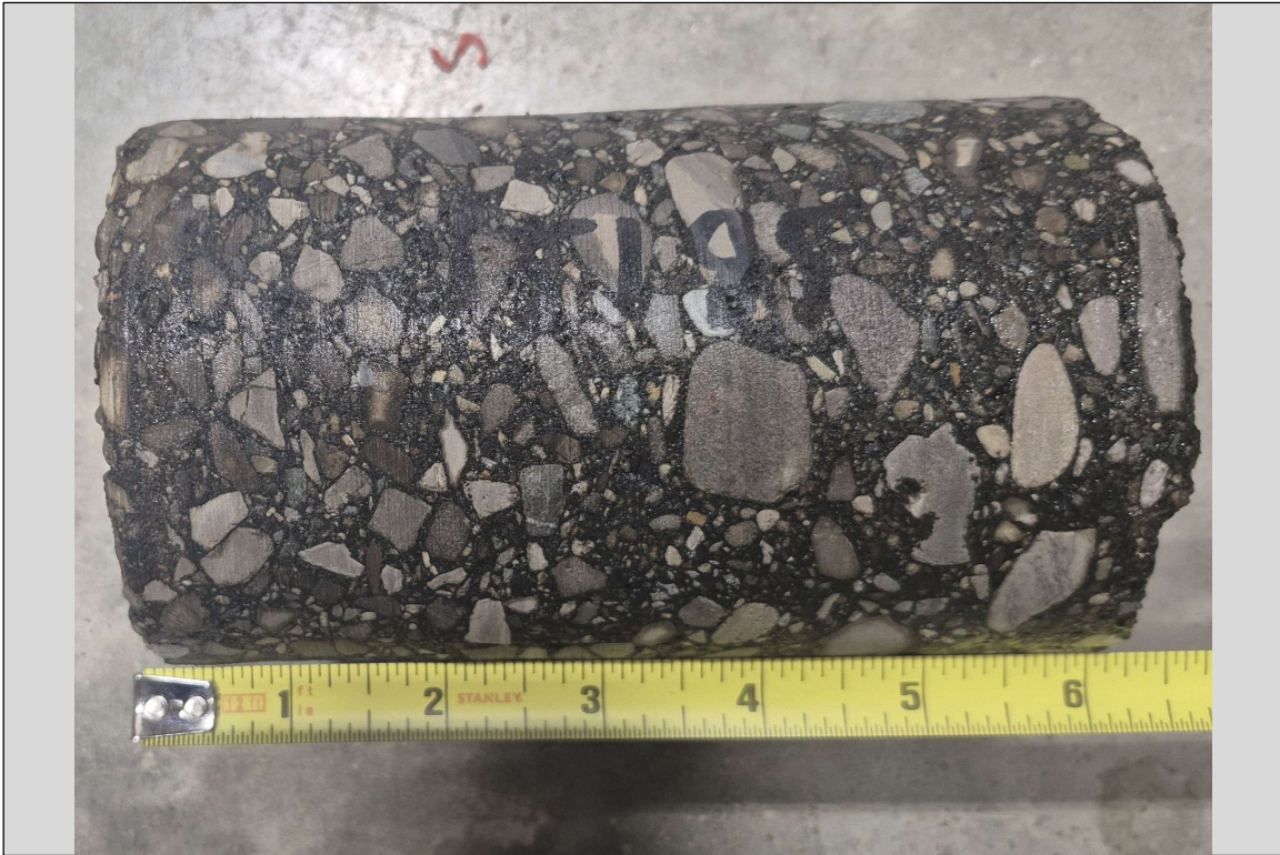
Photo 23: SB-2026-131 (S. Huron Pkwy.): 6.5-inch Asphalt
