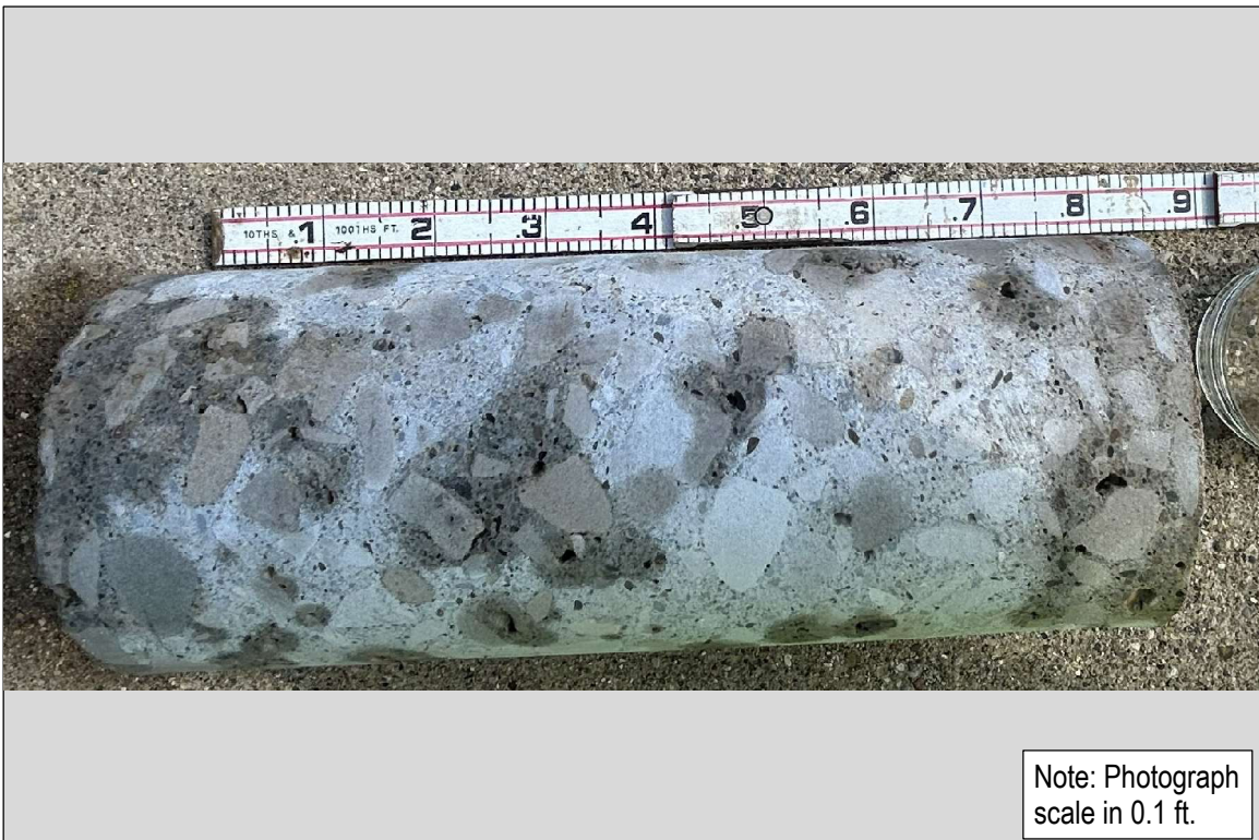
Photo 18: SB-2026-125 (S. Huron Pkwy.): 10-inch Concrete
