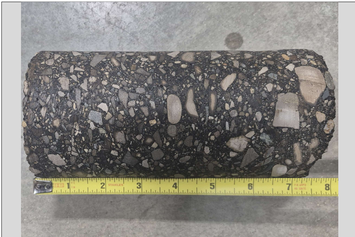
Photo 22: SB-2026-129 (S. Huron Pkwy.): 8-inch Asphalt
