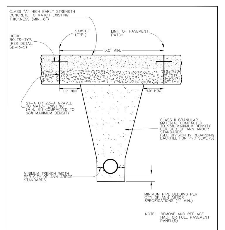
TRENCH DETAILS SHOW TYPE OF BACKFILL AND SURFACE RESTORATION ONLY. NOTE:
