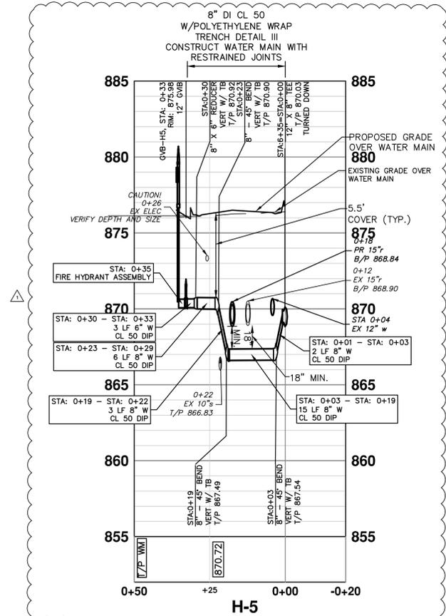
RESTRAINED JOINT SYSTEMS SHALL BE UTILIZED ON ALL WATER MAIN. RESTRAINED JOINT GASKET SYSTEMS ARE TO BE USED. (FIELD-LOK 350 BY U.S. PIPE, FAST-GRIP BY AMERICAN DUCTILE IRON PIPE, OR APPROVED EQUAL).
